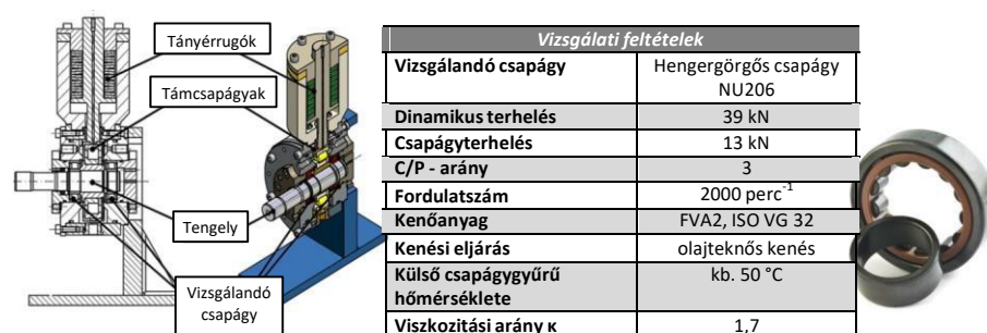
2. ábra: Az IME intézet radiális csapágy-vizsgálópadja és a vizsgálati feltételek
